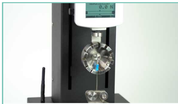
Pomiar siły wrywania przewodu ze złącza
